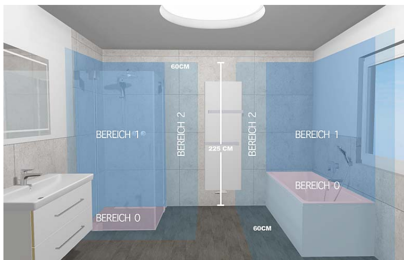
Montagevorschriften Schutzbereich Bad/Nasszelle
